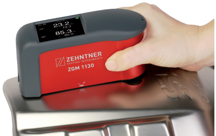
Gloss measurements on metals / Glanzmessung auf Metallen
