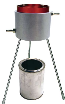
恆溫腳架 需搭配恆溫循環槽
