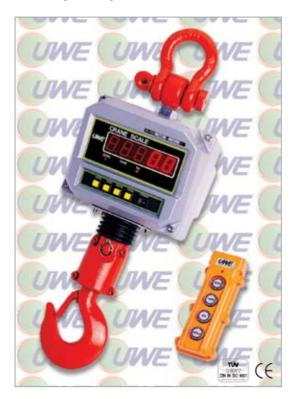
針對工業需求而設計的重負載型吊秤,最大秤量高達 15 噸結構紮實、堅固可靠,展現精良的製造品質與材料標準 AC/DC 雙電源設計,蓄電池組可供 300 小時不斷電操作(LCD 機型)自動校正、自動歸零、全段扣重、讀值鎖定、快速計算平均重量、自動省電(CS-500...CS-7.5T)、旋轉掛勾(CS-500...CS-3T)、公制/英制單位(選配)
