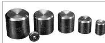
已校正精密砝碼：測試範圍可擴大至 0.1...10,000 挺度單位
