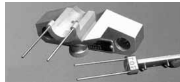
高感度附件：0.1...1.0 極低挺度範圍，適合塑膠片、紡織品、紙張...
