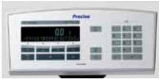
**IT型面板** (選配)：具備IB型基本功能，並增添0...9數字輸入鍵、動態差重計算 (Dynamic Differential Weighing)、自定最小樣本重量 (Minimum Sample Weight)、固/液體比重直讀
