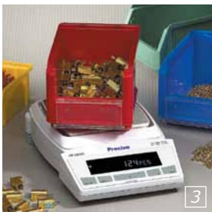
大型秤盤導流蓋，提高秤量準確度
