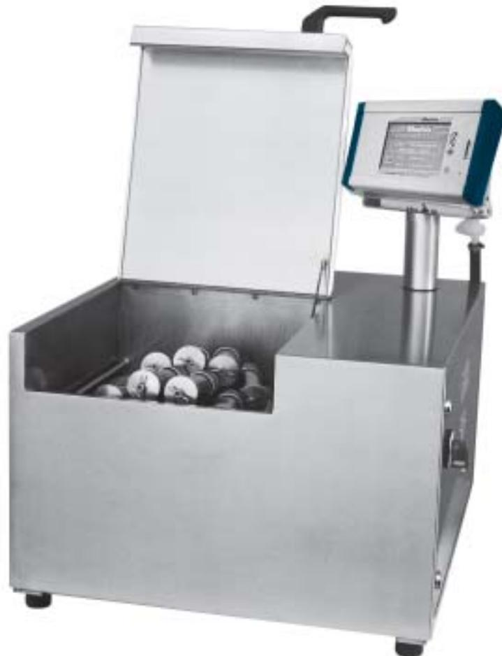
Auf einem übersichtlichen Display kann wahlweise die Färbekurve des laufenden Programms mit aktualisierter Positionsanzeige oder können die entsprechenden Programmangaben im Klartext dargestellt werden. Die aktuelle Temperatur sowie Statusangabe für Heizen oder Kühlen sind jederzeit sichtbar.
