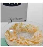
高強度LED光源在明亮作業現場、或外表黝黑物件皆可偵測。每秒6次掃瞄增加取樣面積、提高平均一致性。高度補償可修正不平整之樣本表面、或不規則輸送速度下的測值。先進濾鏡可分離出背景色、或樣品是否符合誤差範圍,精密距離偵測器還可評測樣本不同面之色彩值
