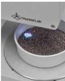
0°/30° 反射式光學系統，評測結果與肉眼最為接近，結構採用密閉式設計，清潔保養容易，不論生產現場、實驗室皆可使用。此外，D25 NC 具備智慧型「物件高度」辨識功能，當偵測色彩時能同時分析樣本高度、並自動完成補償，使色彩讀值不致因高度差異而有所不同；此外還能自動忽略樣本盤底色，只針對樣品本身準確測量！
