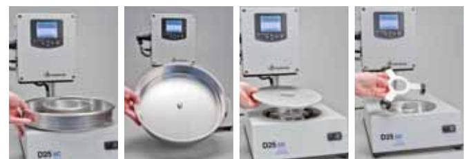
實驗室內、或生產現場皆可使用，維護簡單，不需工具即可將轉盤及底座拆卸下來進行清潔，幾分鐘內即可組裝回去，繼續進行測量
