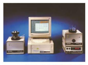
OSMOMAT 070 需與 SA 或 B 型控制組件搭配使用(詳見後述)。 本方法適合測量聚合物之平均分子量,樣本需溶於多種有機溶劑 或水溶液中測量滲透壓,前者範圍 50...50,000 g/mol、後者範圍 50...5,000 g/mol。在充滿溶劑飽和蒸氣的恆温測試室內,裝置2 組精密熱敏式温度感應器,利用溶劑與溶液間產生的温差,來測定 有機溶劑或水溶液中的平均分子量。
