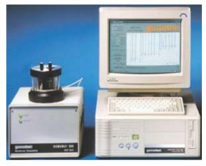
OSMOMAT 090 需與 SA 或 B 型控制組件搭配使用(詳見後述)。 薄膜式渗透壓計,可測量水溶液或有機溶劑中,聚合物的 Mn 平均分 子量,其範圍可達 5,000...2x10<sup>6</sup> dalton。OSMOMAT 090 具有 1 組不鏽鋼精密恆温滲透室,以半透薄膜分為上下兩部份。下槽密封 裝入純溶劑,並設有精密壓力感應系統;上槽具有彎曲狀通道,使 待測樣本能流經最大接觸面積,內建通氣管與排出裝置,使滲透室 能自動沖洗與裝填。由於溶劑與溶液之滲透壓差在下槽産生真空, 適足以表現可滲透活性溶離粒子濃度。
