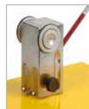
將硬度計直立，即可正確安裝測試鉛筆，不需調整水平
