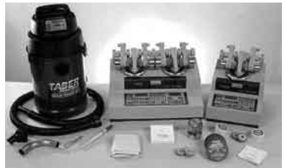
由左至右：真空吸塵器、雙磨輪5155型、單磨輪5135型
