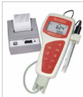
pH 110 具備RS232C輸出埠 可外接電腦或印表機，亦可選購 電源供應器作長期監測
