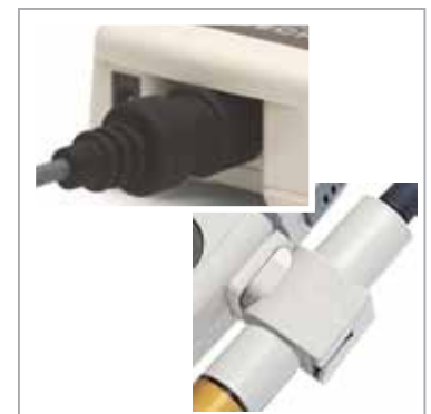
CON 400 防水型符合IP67防護等級 電極插座具防水橡膠護套(上圖)、以及 可調式電極固定器(下圖)
